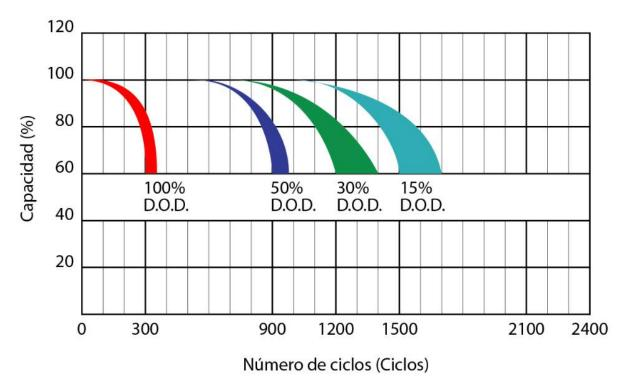
El uso normal de la batería del K1 está en el 15% de profundidad de descarga.
